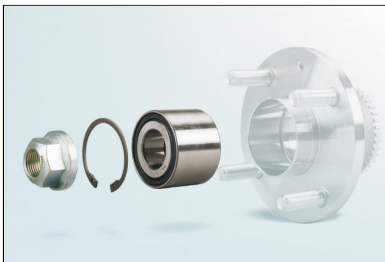
Рис. 1: Комплект ступичного подшипника FAG 713 6448 00 в качестве ремонтного решения - ступицу заменять не потребуется.
