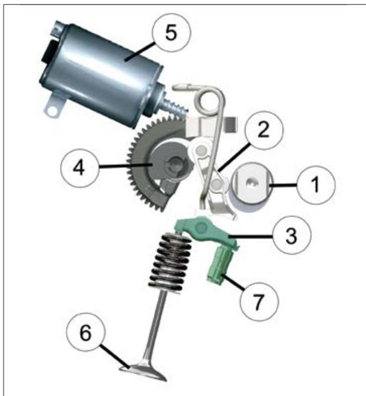
Рисунок 3: Детальный вид компонентов системы Valvetronic для BMW
