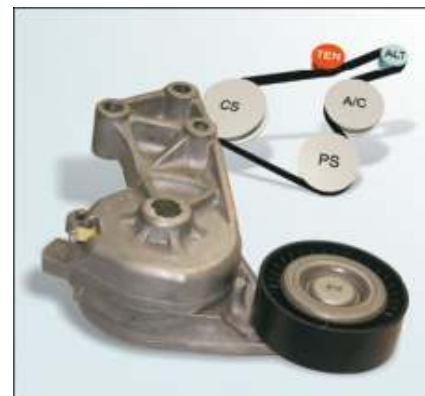
Рис. 2: Натяжитель 534 0132 30, установленный на двигатель 1.9 TDI со схемой расположения ремня.
