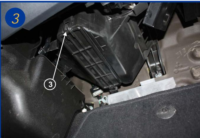
Retirer le couvercle du boîtier filtrant en agissant sur la patte de fermeture (3).
