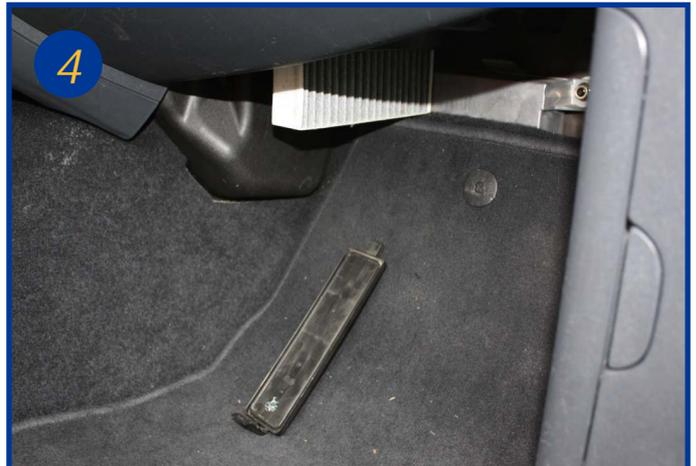
Sortir le filtre usagé et le remplacer.
