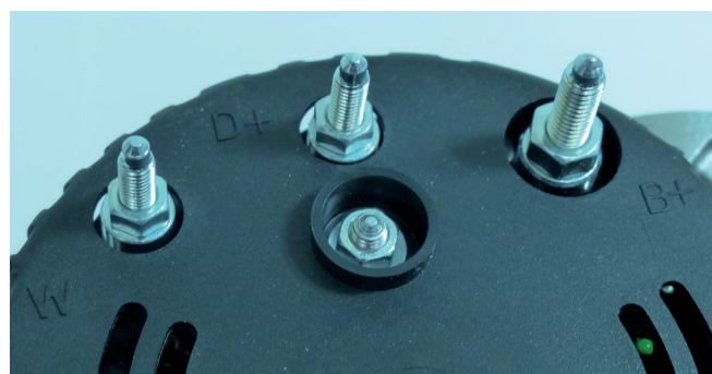
Рисунок 2: Маркировка клемм на генераторе:
