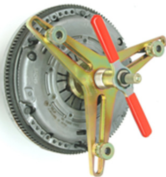
Рис. 3: Зажимное приспособление с центрирующим стержнем
