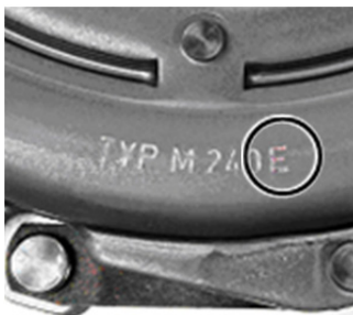
Рис. 2: Все сцепления типа Xtend обозначаются дополнительной буквой E. Пример: M 240 E
