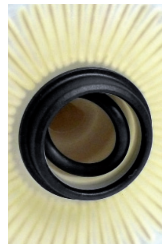
Abbildung 4: Dichtung im Filter stecken geblieben
