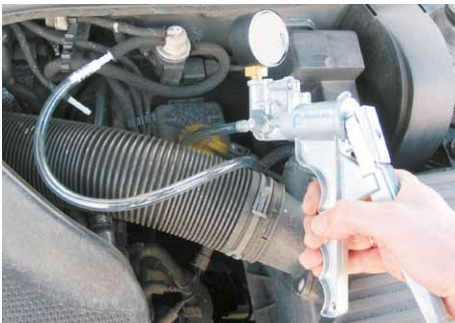
Проверка клапана EPW с использованием ручного вакуумного насоса (автомобиль VW Golf IV)
