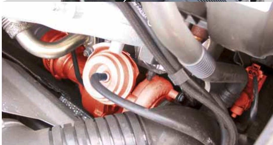
Клапан EPW и VTG-турбоагнетатель (выделено красным) в автомобиле A4 TDI
