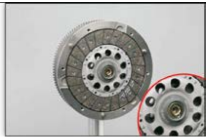
Рис 6: Открутите винт с центрирующей втулки.
