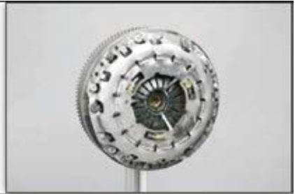
Рис 9: Удалите центрирующую втулку с помощью винта.
