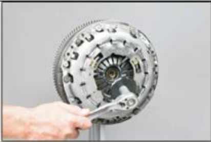
Рис 8: Открутите фиксирующий элемент специальным инструментом и снимите. Он больше не потребуются.
