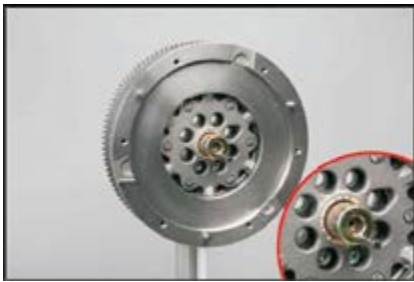
Рис 4: Установите центрирующую втулку перед установкой сцепления. (Обратите внимание на установочный винт).
