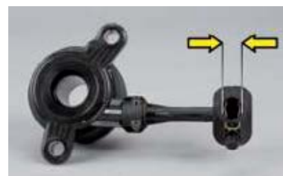
Рис. 2: LuK CSC 510 0097 10 с гидравлической муфтой 13.3 мм.
