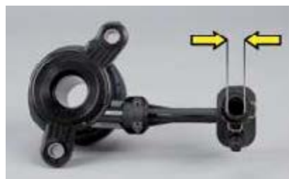
Рис. 3: LuK CSC 510 0098 10 с гидравлической муфтой 11.7 мм.
