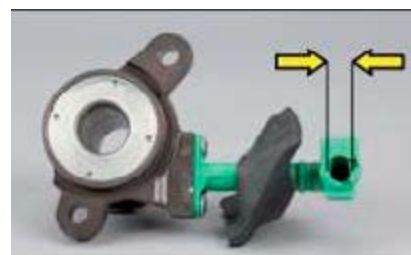
Рис. 2: LuK CSC 510 0137 10 с гидравлической муфтой 12.2 мм.
