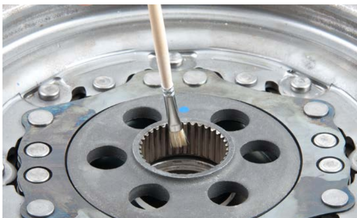
Рис. 1: Небольшое количество смазки должно быть нанесено на внутренние направляющие шлицы во время обслуживания
