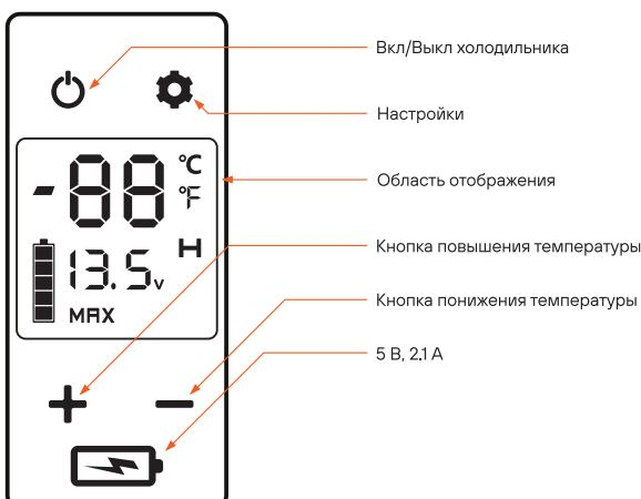
1. Включение и выключение питания: нажмите и удерживайте кнопку выключателя питания в течение 3 секунд, автомобильный холодильник запускается или выключается.
